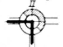
Schaltstellungen des Dreivegehahns
